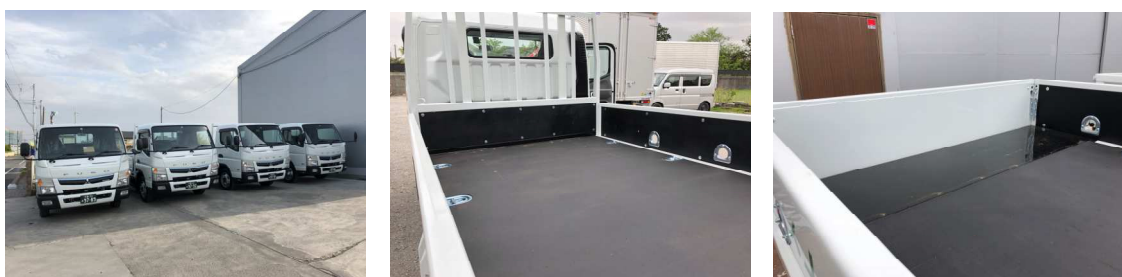
16日に納車された3t平車4台 重量物に対応できるように、鳥居と荷台の一部を架装
